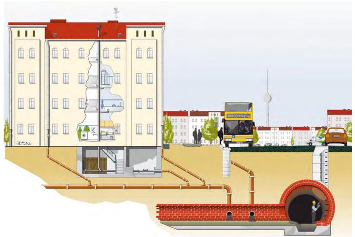
Abb. 16: Mischwasserkanalsystem, in dem Schmutz- und Regenwasser gemeinsam in einem Hauptkanal abgeleitet werden | Quelle: BWB
